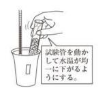
③コップの表面がくもり始めたときの水温をはかる。 (水滴がつき始めたときの 温度が露点となる)
